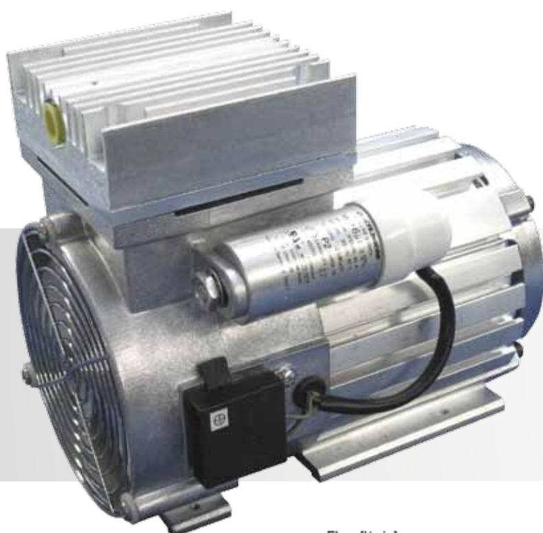
Die ölfreien und trocken verdichtenden Kolbenpumpen der Produktlinie PB-36 dienen zum Evakuieren, Fördern und Verdichten von Gasen und Dämpfen bis zu einem Endvakuum von **90 mbar**. Innerhalb der Produktlinie werden vier verschiedene Baureihen angeboten.
