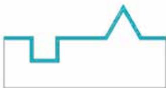
hyco Vakuumtechnik bietet als Qualitätsbeschichtung nur den chemischen Nickelüberzug mit einer Schichtstärke von ca. 15my an, da dickere Beschichtungen brechen können. Dieser ist absolut porenfrei und überall in gleicher Stärke aufgetragen. Es gibt keine Schwachstellen und Angriffspunkte an Ecken, Bohrungen, Gewinden, wie dies beim galvanischen Nickelüberzug der Fall ist.
