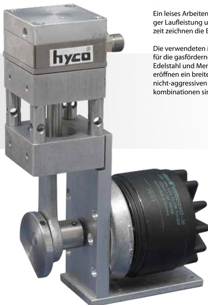
Die ölfreien und trocken verdichtenden Klein-Messgasmembranpumpen der Produktlinie PB-32 dienen zum Evakuieren und Verdichten von Gasen und Dämpfen bis zu einem Endvakuum von **104 mbar**. Innerhalb der Produktlinie werden vier verschiedene Baureihen mit weiteren Modellen angeboten. Die Pumpen sind bis 230° thermisch belastbar.
